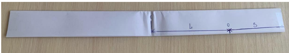
Рис. 3. Фиксация положений точки опоры и центра тяжести листа
